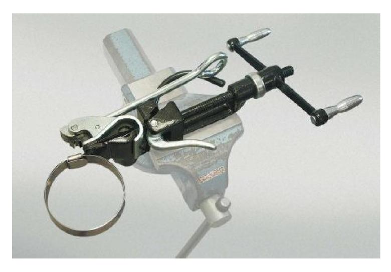
Наносите с помощью Bandimex Tool W 001 и Bandimex Adapter V 001 (a) или V 050 (b). Поместите инструмент Bandimex в тиски, наденьте адаптер Bandimex на носик инструмента. Вставьте предварительно отформованный зажим в инструмент и зажмите хвостовой конец с помощью эксцентрикового рычага.
